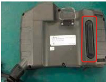
圖 5.13 手持式教導器 Enable switch 圖示
