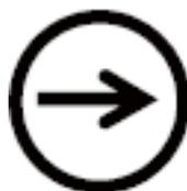
圖 4.3 緊急停止安全斷開符號
